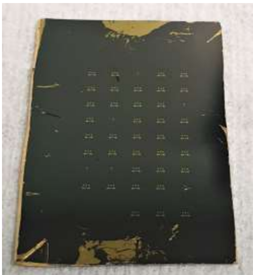
Fig. 24. Sinapsa artificială grafenă/HfGeO/Si realizată la nivel de plachetă.
