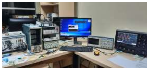
Fig. 1. (a) Sistemul de măsură Sawyer-Tower P(E) , și (b) P(E) pentru \text{HfZrO} și \text{HfAlO} cu grosimea de 6 nm depuși direct pe Si dopat. Contacte: 150 \mu\text{m} \times 150 \mu\text{m} Cr (5 nm)/Au (200 nm)
